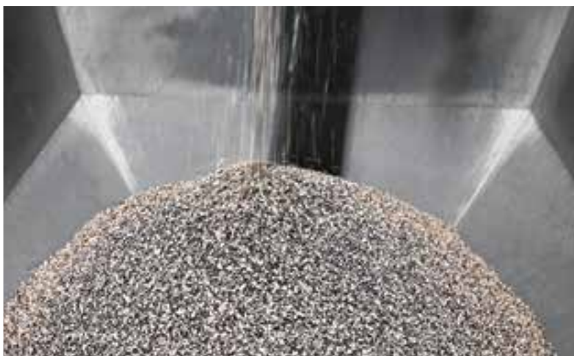
Gebrauchte Dachmembranen werden gesammelt und zu Granulat verarbeitet. Das rezyklierte Material fließt in die Produktion neuer Dachabdichtungen ein.
